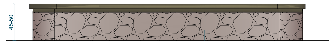
Remontuojamos esamų suolų akmens mūro atramos
